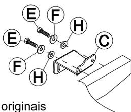
1. Retirar os parafusos originais da pick-up situados na ponta do chassi logo a frente do radiador na parte inferior.
