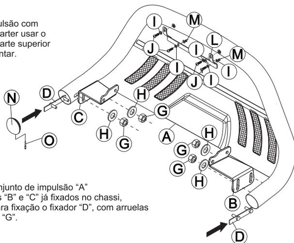
Montar o conjunto de impulsão "A" nos suportes "B" e "C" já fixados no chassi, utilizando para fixação o fixador "D", com arruelas "H" e porcas "G".
